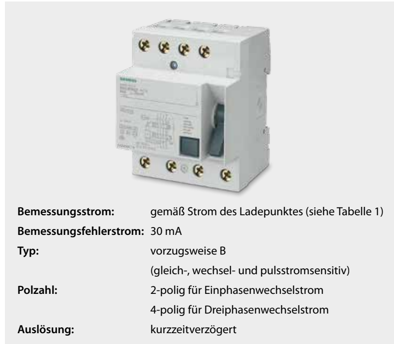
Bild 10: Fehlerstrom-Schutzschalter mit Kenndaten
