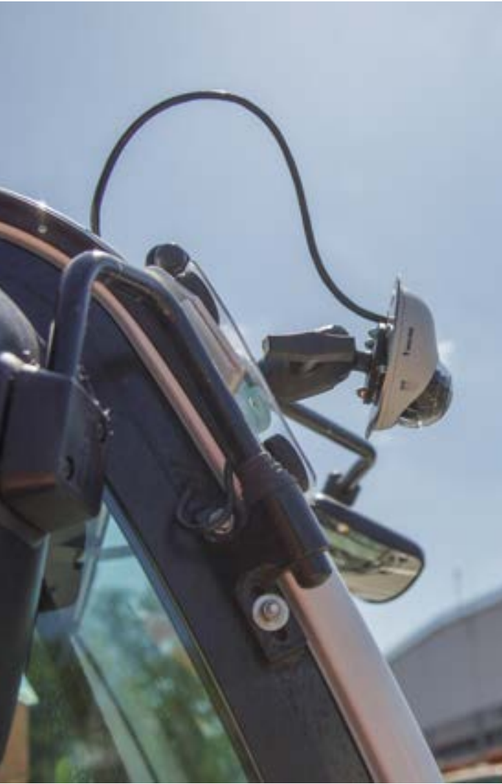
Kamera des Cortexia-Systems, das mittels KI dabei hilft, einen genauen Überblick über Verschmutzungsgrade zu erhalten.
